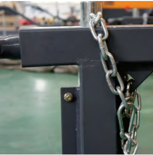
铁质的安全锁链与拖车永久相连独立承受外力保护主机不易变形
